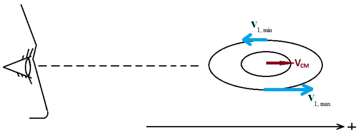
$$\begin{cases} v_{1,max} = v_{10} + v_{CM} & (1) \\ v_{1,min} = -v_{10} + v_{CM} & (2) \end{cases}$$
